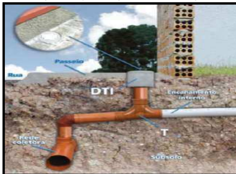
Figura 7: Proposta de liga  o domiciliar de esgoto
