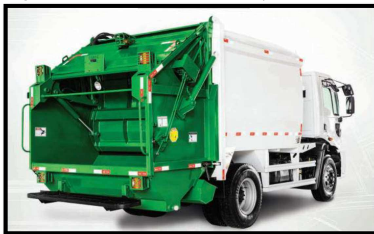
Figura 12: Modelo de caminhão com compactador de 10 m³
