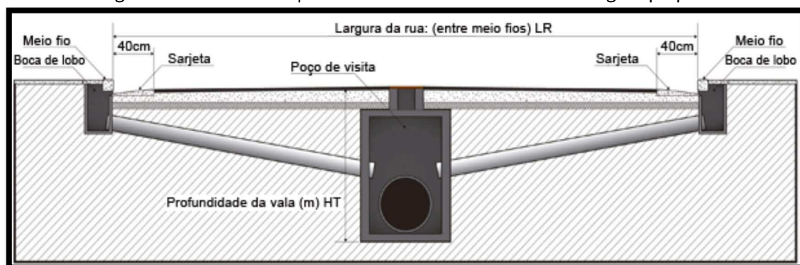
Figura 10: Desenho esquemático do sistema de micro drenagem proposto
