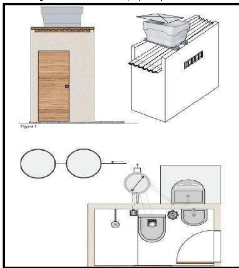
Figura 8: Módulo Sanitário proposto para zona rural
