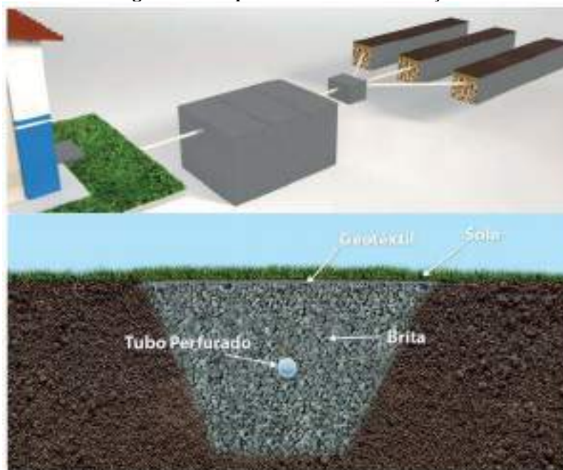
Figura 23 - Esquema de vala de infiltração.
