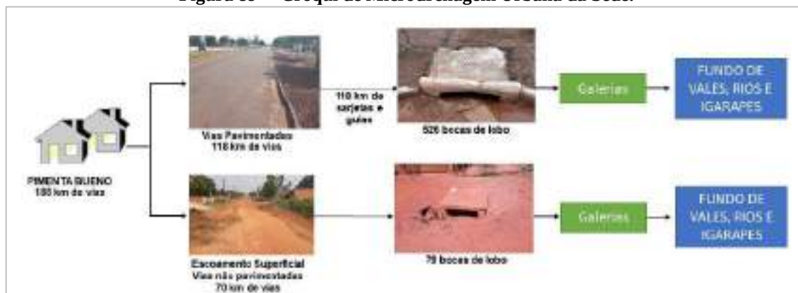
Figura 89— Croqui de Microdrenagem Urbana da Sede.
