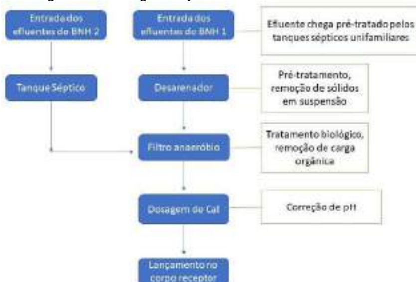
Figura 68— Fluxograma operacional da ETE da Sub-bacia B.
