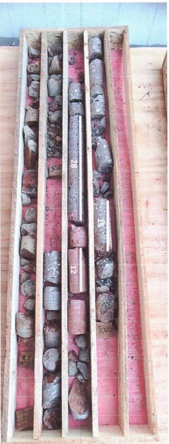
Figura 8 - Caixa de testemunhos SM 01
