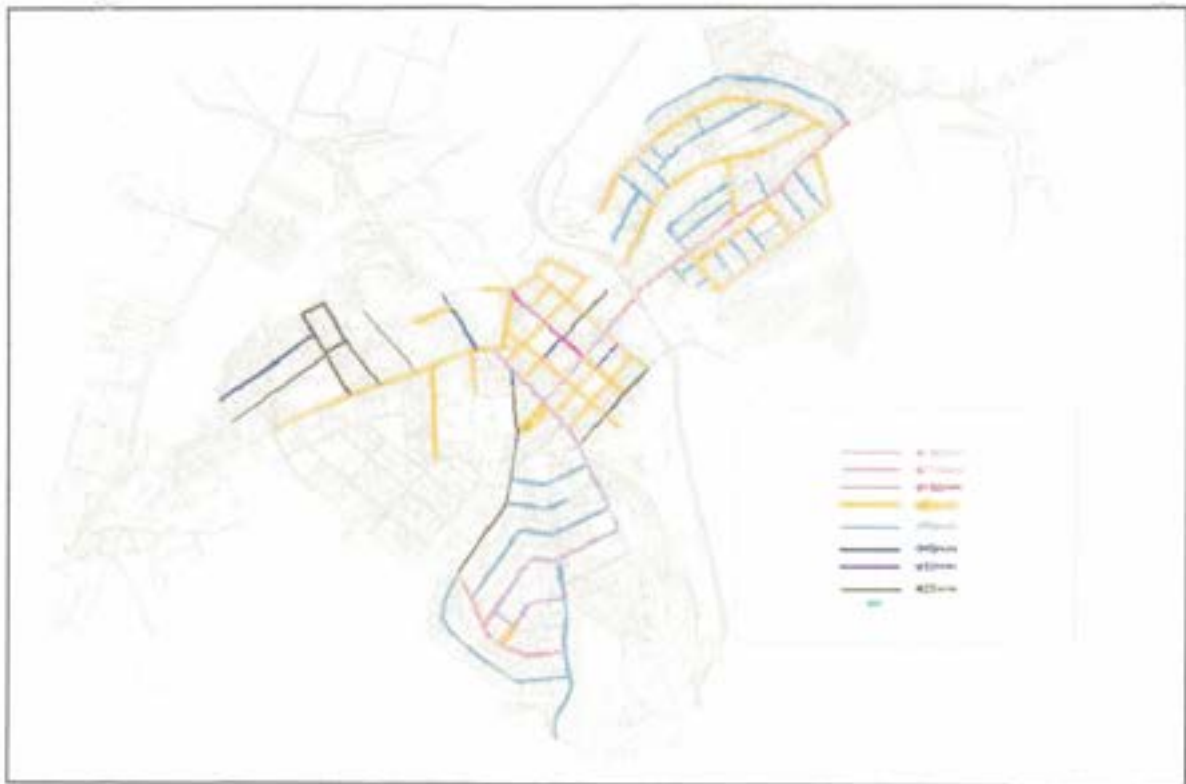
Figura 32 – Cadastro da rede de distribuição de água
