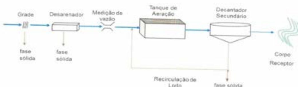
Figura 36 – Esquema geral de uma Estação de Tratamento por Lodo Ativado
