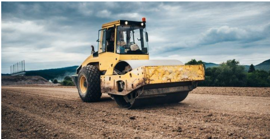
Figura 4 - Exemplo de rolo compactador liso para compactação e acabamento do cascalhamento.
